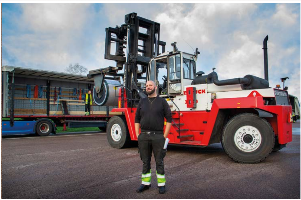
Truckföraren Tobias Amilon ska strax lyfta på den 14 ton tunga stålrullen på den för transportuppdraget specialanpassade trailern i bakgrunden. Tobias ber föraren att flytta tillbaka godsstöttorna ett hack. "Då får han 10,5 ton på drivaxeln", förklarar han.
